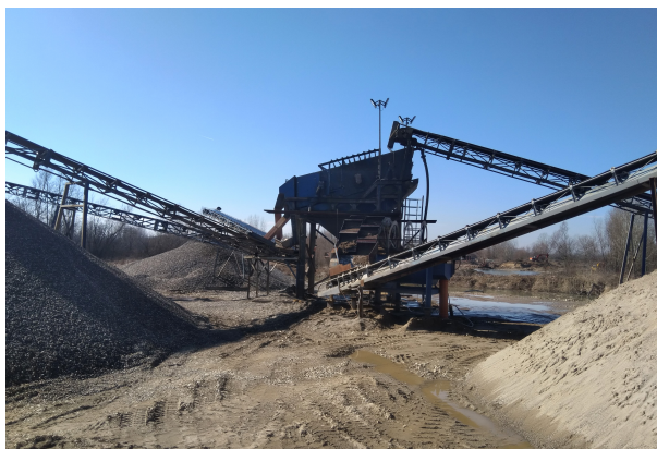
Слика 2. Постројење за сепарацију агрегата
